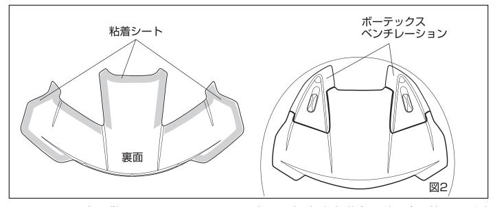
取りはずしは、布を巻きつけたマイナスドライバーなどを矢印部分(図1参照)に差し込み浮かせたのち、エアロ エッジ スポイラーを後部サイドより徐々に前へ裏面の粘着シート(図1点線部分)からひきはがすように取ります。取った部分のシェルは粘着シート、ゴミ、ホコリを取り脱脂し、きれいな状態にしてください。取り付けは、ボーテックスベンチレーションがついた状態で行ってください。新しいエアロ エッジ スポイラー裏面の粘着シートの保護フィルムをはがし、全体をシェルのくぼみとボーテックスベンチレーションに合わせ、図2の状態になるように取りつけます。取り付け後は、粘着シート部分を上からよく圧着してください。
