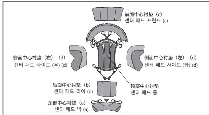
中心衬垫由顶部中心衬垫、颈部中心衬垫 (a)、后面中心衬垫 (b)、前面中心衬垫 (c)、侧面中心衬垫 (d: 左右侧各1个) 6个部件构成。可通过改变各部件的厚度调整服帖感。
