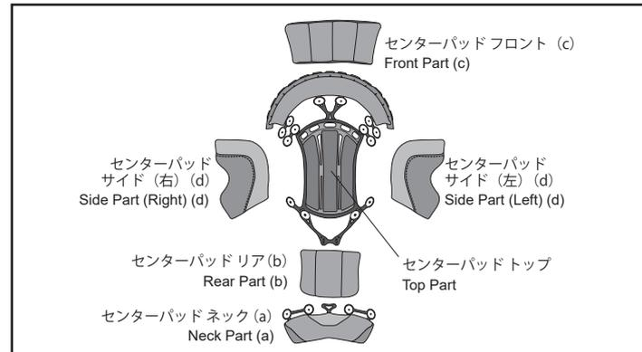
センターパッドは、センターパッドトップ、センターパッドネック (a)、センターパッドリア (b)、センターパッドフロント (c)、センターパッドサイド (d: 左右各1つ) の6つのパーツで構成されています。
