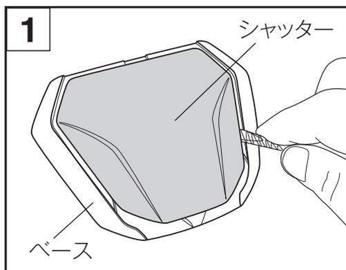
J-Cruise アッパーエア インテークの取り外しは、図1のようにシッターを全閉～全開の中間位置に合わせた状態で、シッターとベースの隙間にマイナスドライバーなど先の平らな道具を差し込み、こじるようにしてシッターを外します。次に、ベースを固定しているビス(3か所)を取ります(図2)。取り外し後、シェルの表面のゴミ、ホコリ、油分を取り除いてください。
