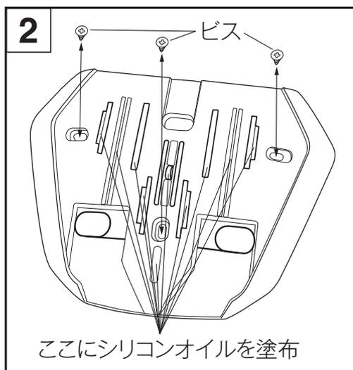
取り付けは、ビス穴と吸気口をシェル側の穴と合わせ、付属のビスで3か所を固定してください。次に、ベースのレールと溝の部分(図2参照)およびシッターの爪に、少量のシリコンオイル\*を塗り、シッターの爪をベースの溝の広がっている箇所を重ね合わせ(図3参照)、図4の点線部分を①→③の順にカチッと音がするまで押しはめ込みます。取り付け後、シッターがスムーズに開閉するか確認してください。
