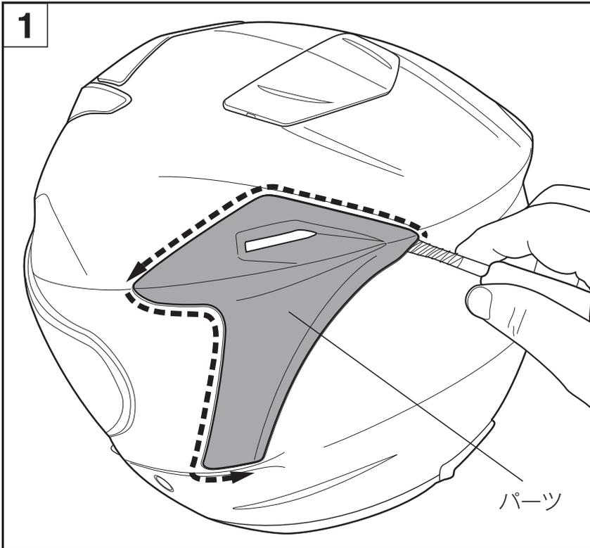
J-FORCE IV サイドエアアウトレットの取り外しは、シェルとパーツの隙間にマイナスドライバーなど先の平らな道具を差し込み、図1のように矢印に添って裏の両面テープをはがしながら、こじるようにしてパーツを外します(図1)。取り外し後は、シェルの表面に残った両面テープ、ゴミ、ホコリ、油分を取り除いてください。
