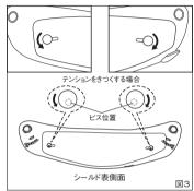
マンションを調節したのち、一度、シールド よりRSティアオフフィルムを取りはずし、 シールドの表面に付着しているごみや油分を 取り除きます。
