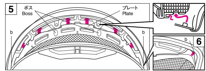
センターパッドの取りつけは、まず前部プレート2ヶ所のボスを差し込みながら、ブレケットのすき間にすべらせるように入れます。プレートの左右の端は元のようにbのすき間(図6)に差し込みます。
