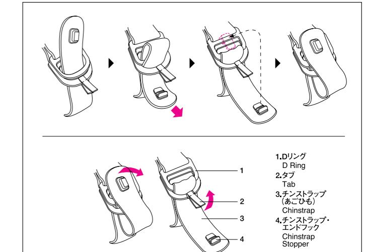
●あごバンドの先端部を固定するのに便利なチンストラップ・エンドフックがついています。使用方法は、Dリングにあごバンドを通して、しっかりと締めた後、チンストラップ・エンドフックをDリングに取り付けます。(図参照)
