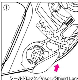
図①の位置にレバーを回転させることで、シールドがロックされます。走行時や転倒時などに、不意なシールドの開放を防ぎます。
