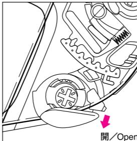
必要最小限の開きをレバー操作一つでプリセッテッド。効果的に導入された走行風が、シールドの曇りを除去・防止するという、SHOEI独自のプリセットオーブニング機構(1段階)です。
