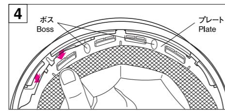
図のようにプレート近くを持ちプレートを引きぬきます。
