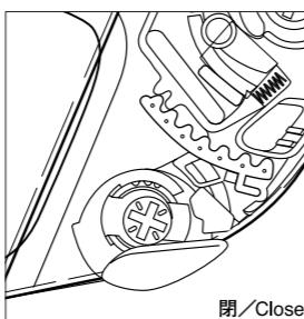
フックをフックレールからはずして、ギアボックスからシールドのセンターギアを取りはずせ完了です。
