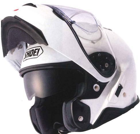
フェイスカバーを全開位置で保持するロックが2段階に設定された。1段階目はヘルメットの着脱時に適したロックポジションで、さらに後方に押し込むことでより強固な保持力を持つ2段階目にすることができる
