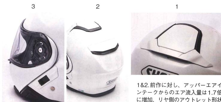
1&2.前作に対し、アッパーエアインテークからのエア流入量は1.7倍に増加。リヤ側のアウトレット形状の最適化により快適性が向上。3.フェイスカバー取り付け部分がよりスマートな形状とされたのに加え、シールド周りも刷新。専用シールドCN S-3に合わせて、窓ゴムの形状も変更され、密閉性が高められている。
