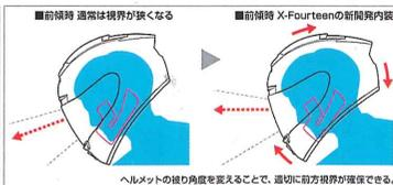
チークパッドとセンターパッドの装着位置を変更することで、被り角度が標準ポジションに対して前方に約4度回転する。その結果、上方視界が得にくいスーパースポーツでも、十分な前方視界を確保しやすい
