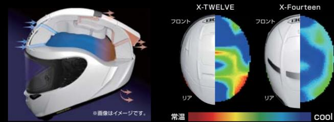
フロント、アッパーから導入した走行風が内部の熱気や湿気を換気
