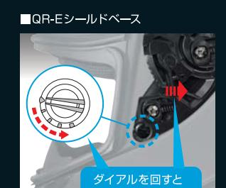
ダイアルを回すこと、シールドベースが5段階にスライド。シールド密着性を左右とも最大1ミリの幅で微調整が可能。
