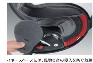
イヤースペースには、風切り音の侵入を防ぐ着脱可能なイヤーパッドを装備。パッドを取り外したイヤースペースの樹脂フレームにはパンチング加工を施し、内部での音の反響を防ぐ効果を持つ。
