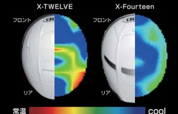
「100Km/h相当の風を30秒送風した時点での温度変化」(当社大型風洞実験施設にて測定した参考値比較)
