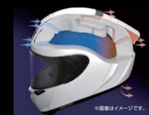
フロント、アッパーから導入した走行風が内部の熱気や湿気を換気
